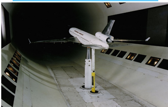
شکل ۱-۵- استفاده از آزمایش تونل باد و روش محاسبات عددی در طراحی مقدماتی هواپیما
